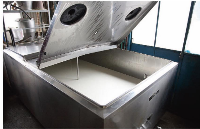
搾乳機で絞られた牛乳は、上部のパイプを通して冷蔵タンクに集められる。
